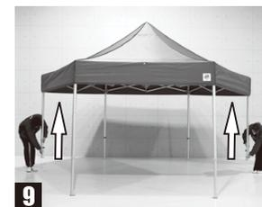
⑨ 最後に対角の2本の支柱を持ち上げて完成です。傾斜や段差のある所では、支柱の高さをそれぞれ調整して、テントを水平に保ってください。
