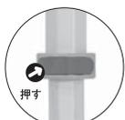
**①** 対角の2本の支柱の高さ調節用ロックを押して、支柱を手で縮めます。
