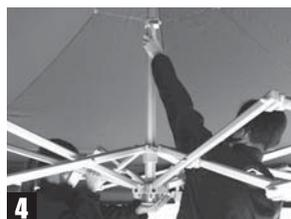
**④** ピークポールのロックを押し、引き下げます。1人が下からピークポールを押し上げると解除しやすくなります。
