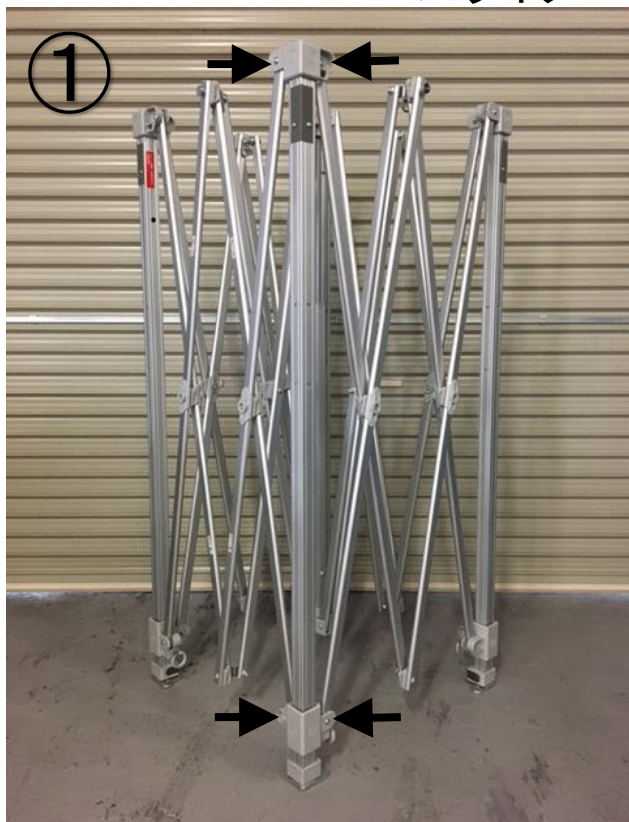
①矢印部分のボルトを外して コーナーポストを取り外す
